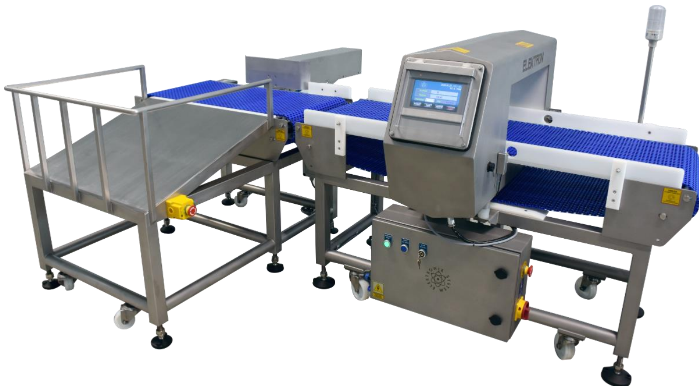
Detektor metali z pochylnią do produktów zapakowanych w worki lub kartony.
